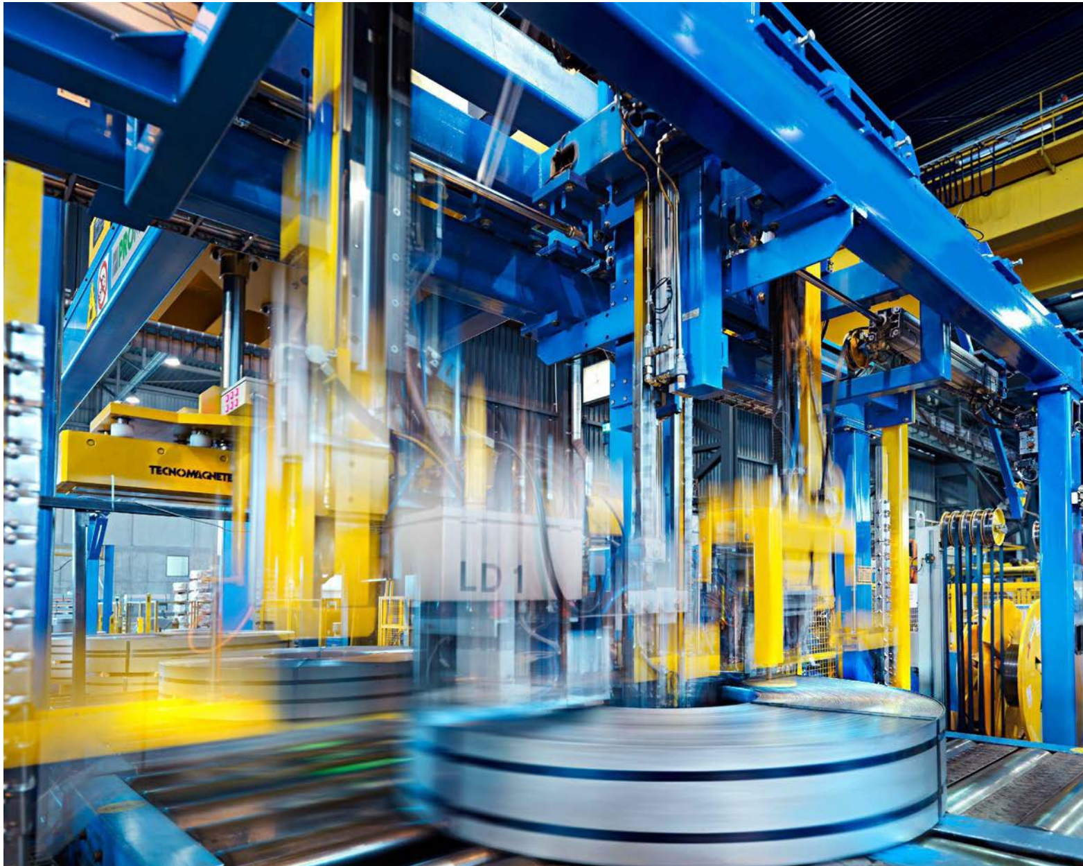
Diese Maschine umreift Stahlcoils. Erst durch die lange Belichtungszeit wird das Bild dieser komplizierten Anlage gerecht.
