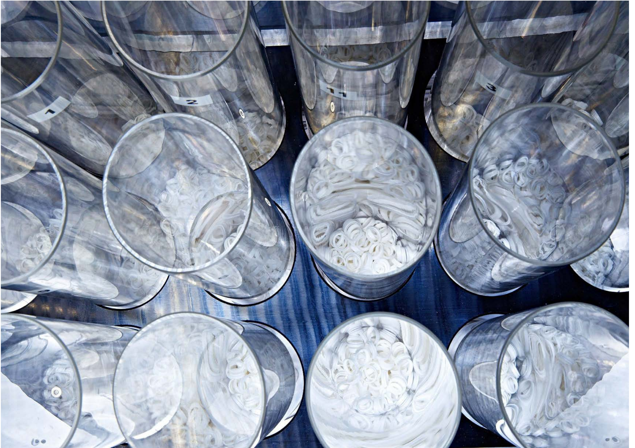
Dichtungsringe werden nach getrennten Chargen sortiert.
